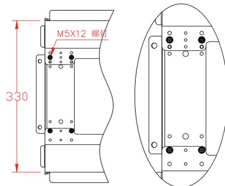
图2 MDXXXT250G(L)-MDXXXT280G(L), MD290T315P(L)-MD290T355P(L)的安装位置示意图
